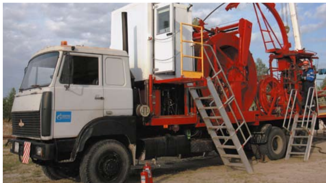
Персонал колтюбинговой установки М-10 готовится к проведению операции по освоению газовой скважины
