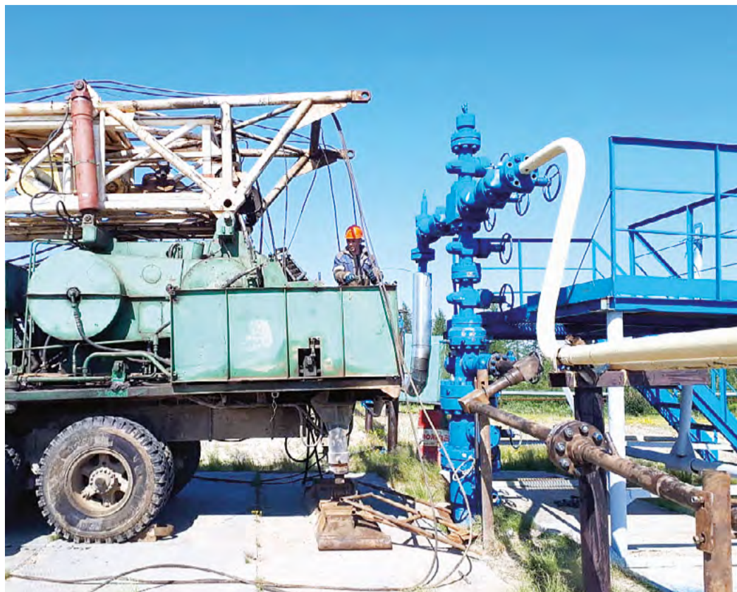
Монтаж подъемника А-50 на устье скважины выполняет бригада КРС-11
