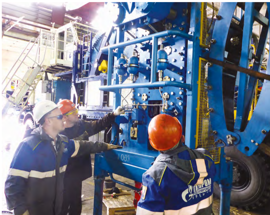
Машинист подъемника Ярослав Литвин, мастер ремонтно-механического участка Андрей Стрелков и слесарь-ремонтник Сунгатула Гусейнов проводят осмотр инжектора колтюбинговой установки УКРС-30 после проведенного ремонта, Уренгойский УИРС
