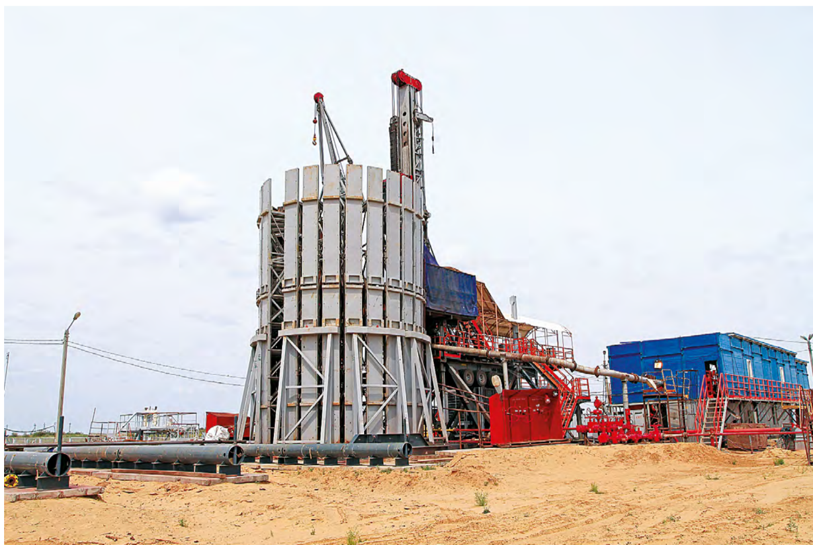
Тяжелая подъемная установка Drilltec применяется для капитального ремонта скважин на Астраханском газоконденсатном месторождении
