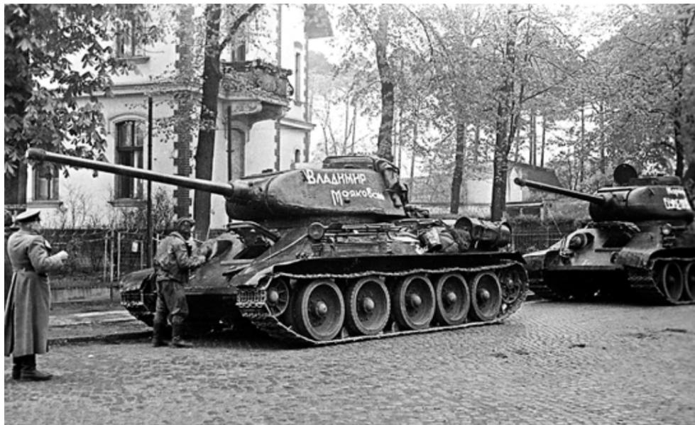
В этом танке гармонично сочетались: огневая мощь, броневая защита и высокая подвижность. Его 76-мм пушка поражала танки противника на расстоянии до 1,5 км. Немцы не могли пробить броню Т-34 и с 500 м. Простота конструкции позволяла быстро обучать экипажи. Среди танкистов были даже женщины.
